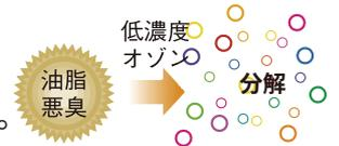
オゾンによる油脂分解は生体化学反応ではなく、純粋な化学反応は広範な環境下で効果を発揮します。バイオ酵素タイプは熱湯、強アルカリ洗剤等が流入すると活動菌・酵素が死滅することがあります。よって管理が困難で、多忙な厨房には不向きです。
