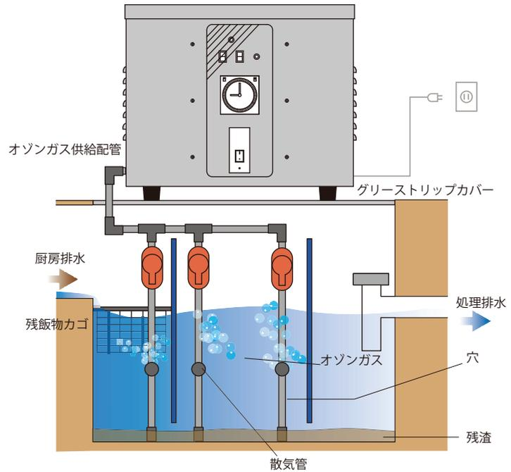
※基本的には最終槽へのバブリングは、攪拌による油分の槽外への流出防止の為、行ないません。第1槽目では残飯物カゴ内残飯が暴れないように中程度のバブリングに調整をします。底面より上部20cm程度でバブリングすることにより残渣の巻上げを防止します。
